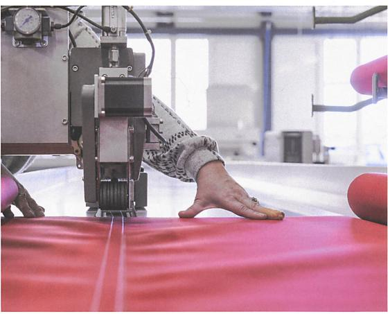
Der auf den Millimeter genau zugeschnittene Stoff wird hier zusammengenäht und aussen gesäumt.
