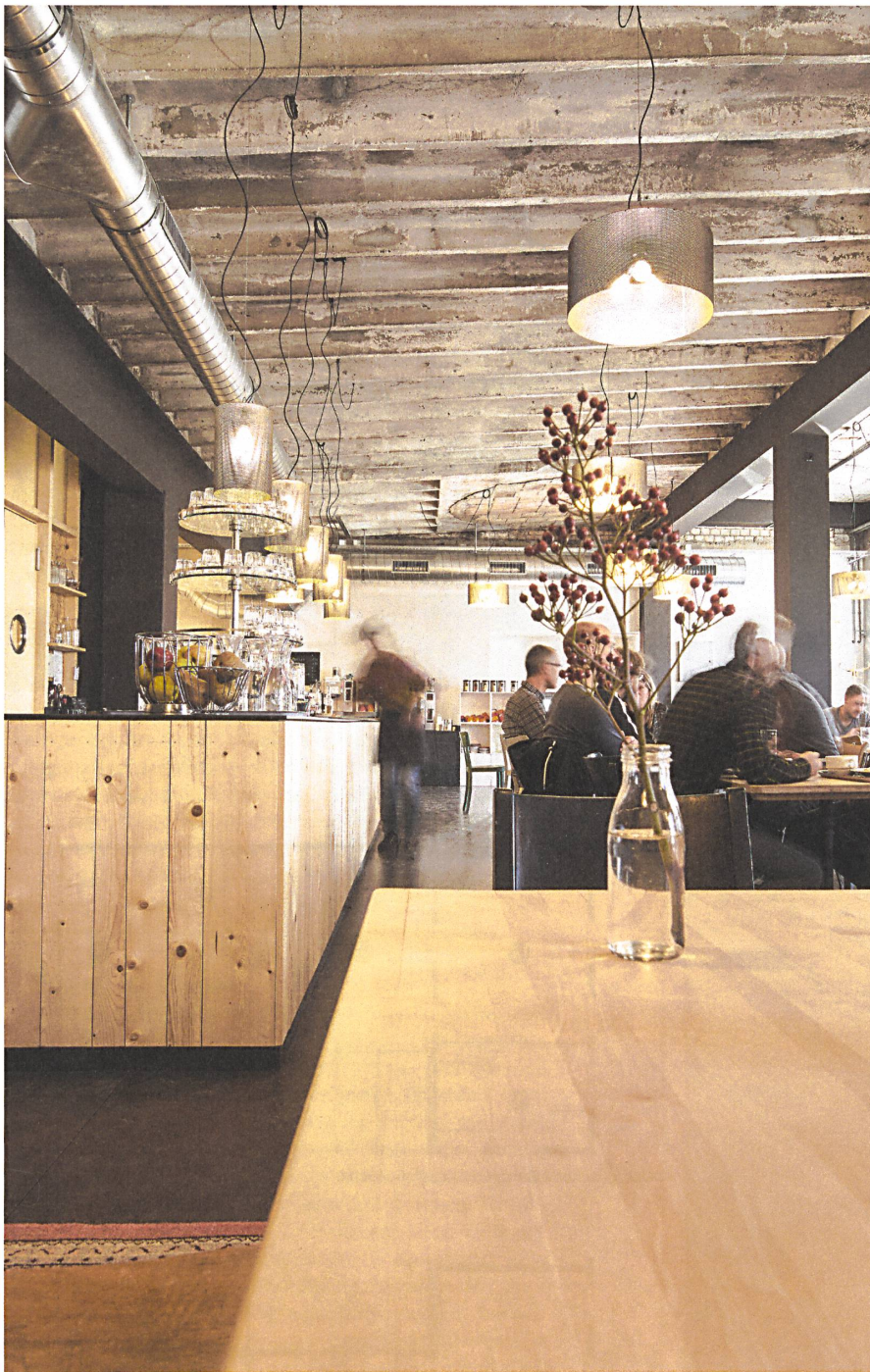
Im Restaurant setzt sich das Bauprinzip fort. Architektonische Sparsamkeit heisst hier: Querbretter zwischen die Pfosten, und fertig ist das Barregal.
