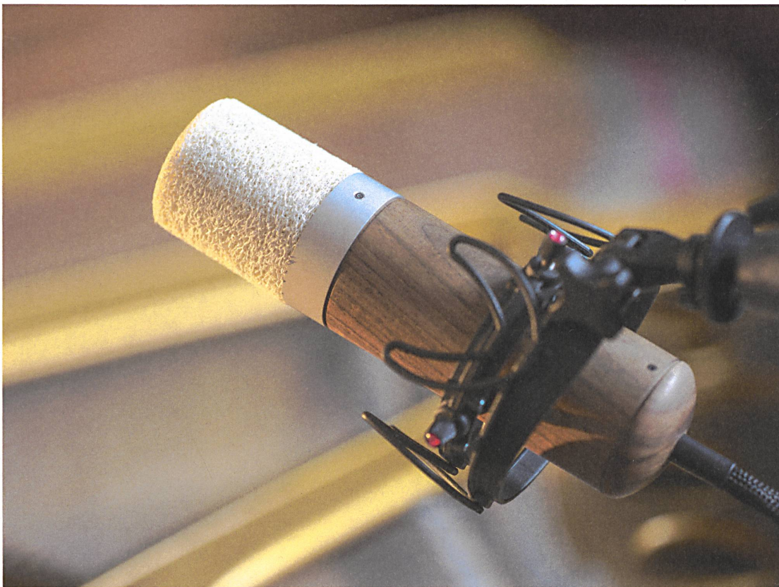
Designer, Biologin und Materialingenieur erfanden ein Mikrofon mit Korb aus Luffa, einem tropischen Kürbisgewächs: Anders als geschäumter Kunststoff schwingt der Schwamm nicht mit.
