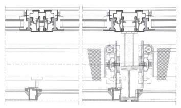
Fensterdetall: bestehende Einfachverglasung – dahinter die neue Fensterschicht. Das innere und das äussere Metallprofil sind durch einen Isolator thermisch getrennt.
