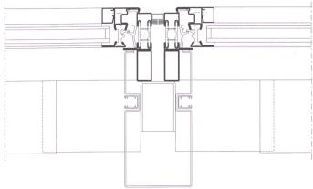
Detail: Angeschweisste Verstärkungsprofile ermöglichen die schlanke Konstruktion.
