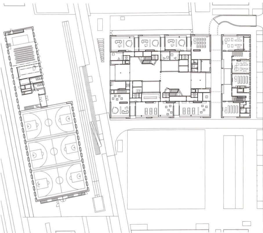
In beiden Doppelhelixtreppen führt die eine Treppe in die Primar-, die andere in die Sekundarschule.
