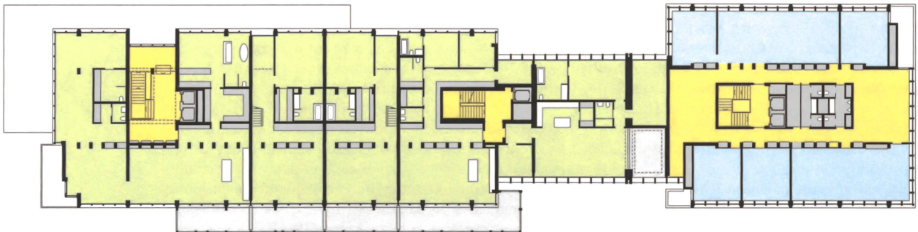
Ebene C: Die Treppenhäuser erschliessen Geschosswohnungen. Im Gebäudeteil rechts sind weiterhin Büros untergebracht.
