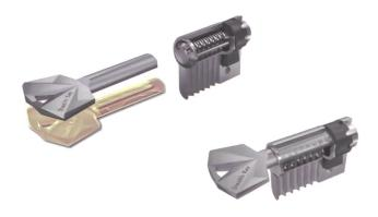
Oben ist der Schlüssel glatt und gerundet, auf der Unterseite klappt die Wandung doppelt nach innen. Im geschützten Raum ist die wellenförmige Struktur untergebracht, mit der die Mechanik des Schliesszylinders interagiert.
