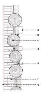
Zwischen den Lärchenholzpflöcken a sitzen konische Holzleisten b an den Balken c und Brettern d. Ähnlich wie früher mit Axteinschlägen und Holznägeln verkantet sich hier der Lehm e. Dahinter dämmt Isofloc f den Hohlraum bis zu den innenliegenden Grobspanplatten g.
