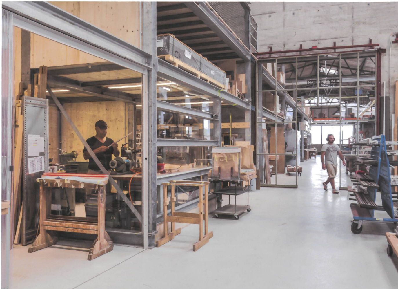
Ein Gestell des früheren Warenlagers liessen Benjamin Thut und Ralf Geckeler stehen und richteten darin die Fertigung für die beiden Produktionen von Thut und Tossa ein. Die Schiebetür in der Mitte der Halle befreiten sie von ihrem Blechkleid und füllten die Holmen mit Glas aus. So fällt der Blick durch die ganze Länge der Halle.
