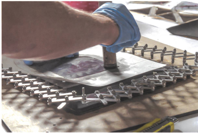
Im Labor der Interaction Designer wird eine Folie beidseitig mit Russ beschichtet.
