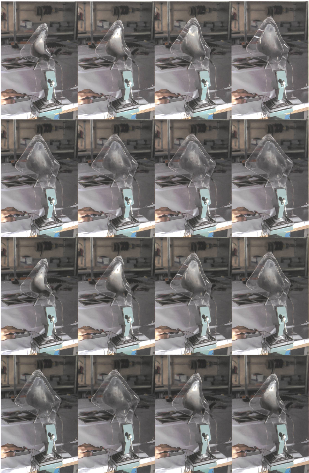
Das «Enactive Environments Lab» erforscht elektroaktive Polymere, hauchdünne Folien, die unter Hochspannung lebendig zu werden scheinen.
