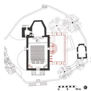
Erdgeschoss mit den Neubauten in Rot.
