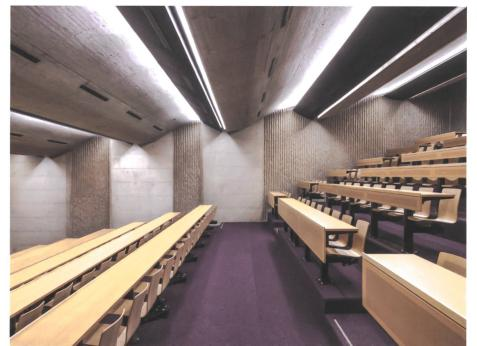
Erstklassige Akustik in den neuen Hörsälen des Universitätsspitals Lausanne: Die Geometrie der Decke und der Seitenwände lässt den Schall dank glatter und rauer Oberflächen schneller oder langsamer fliessen.
