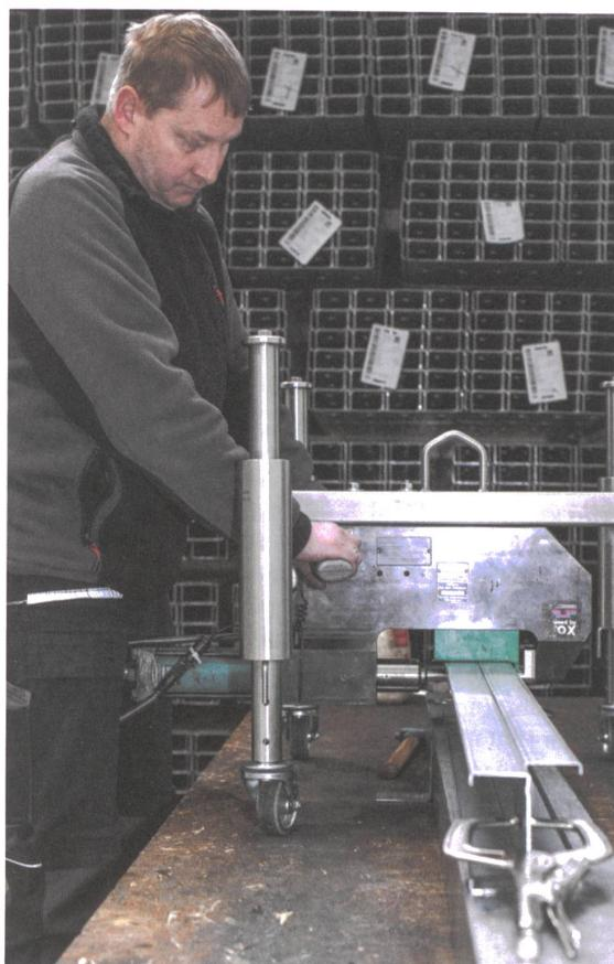
Ein Arbeiter verbindet mit einem Bolzen zwei Profile. | Un ouvrier boulonne deux profilés.
