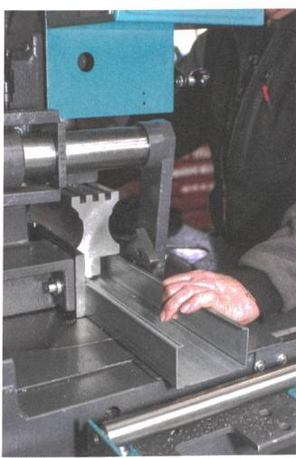
Die Elemente werden auf die richtige Länge zugesägt. | Les éléments sont sciés à la bonne longueur.
