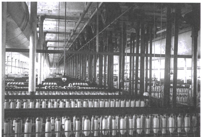
In grossen Sälen standen die meterlangen automatischen Spinnmaschinen (Selfaktoren). So entstanden feine Baumwollgarne.
