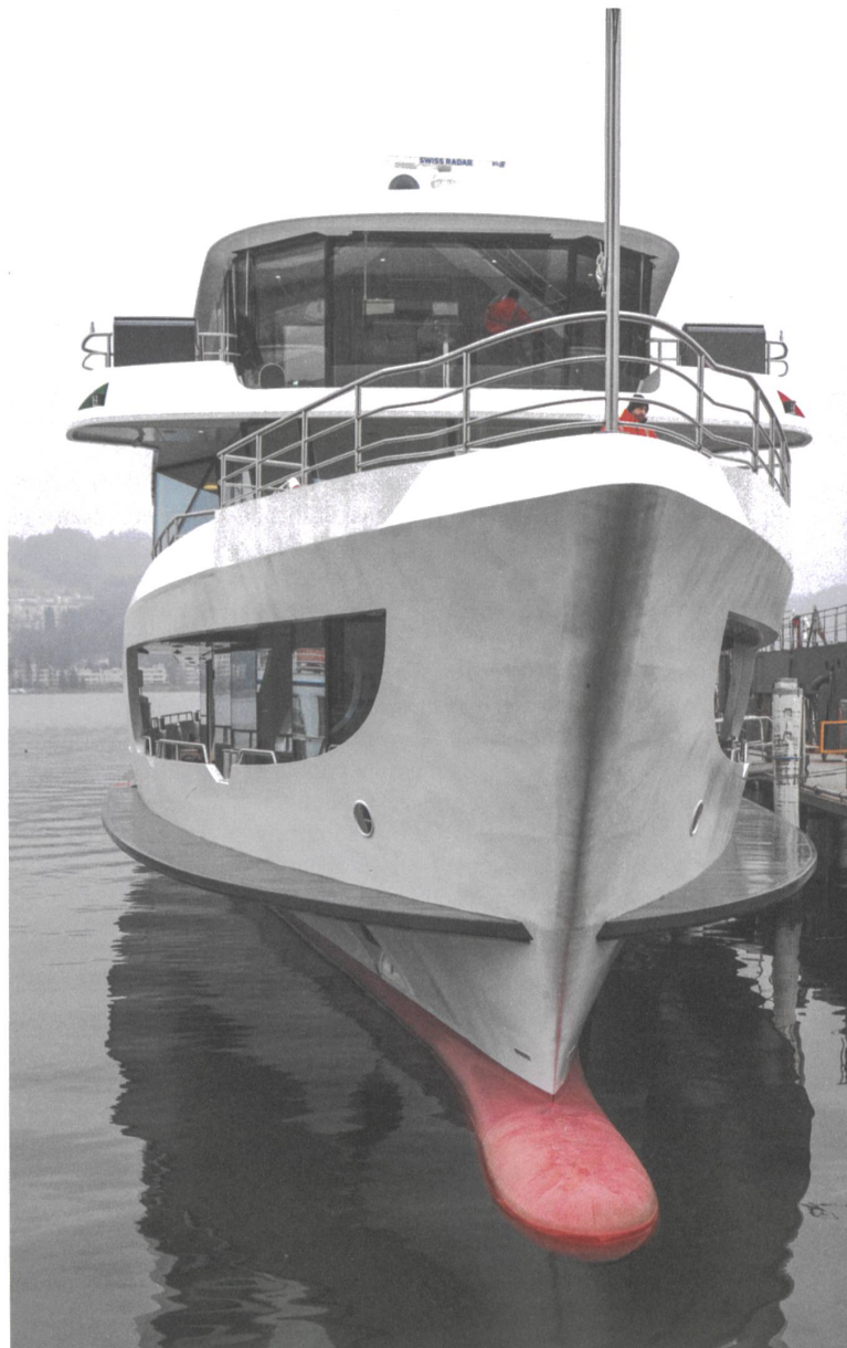
Neustes und grösstes Schiff auf dem Vierwaldstättersee: Sein hochgezogener Bug erinnert an ein Hochseeschiff. Der rote Wulstbug soll hohe Wellen vermeiden.
