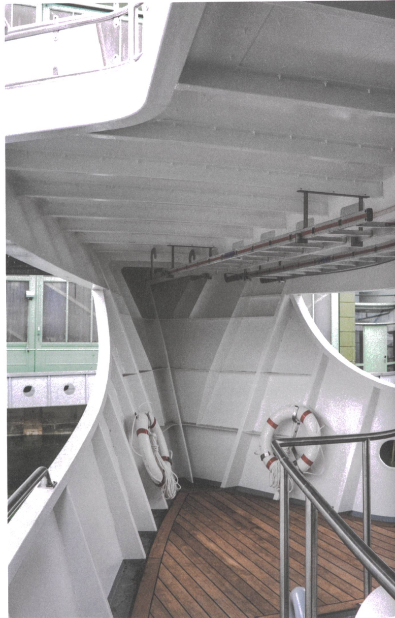
Die beiden Aussparungen links und rechts waren nötig, um dem Kapitän trotz hohem Bug den Blickkontakt zu gewährleisten.
