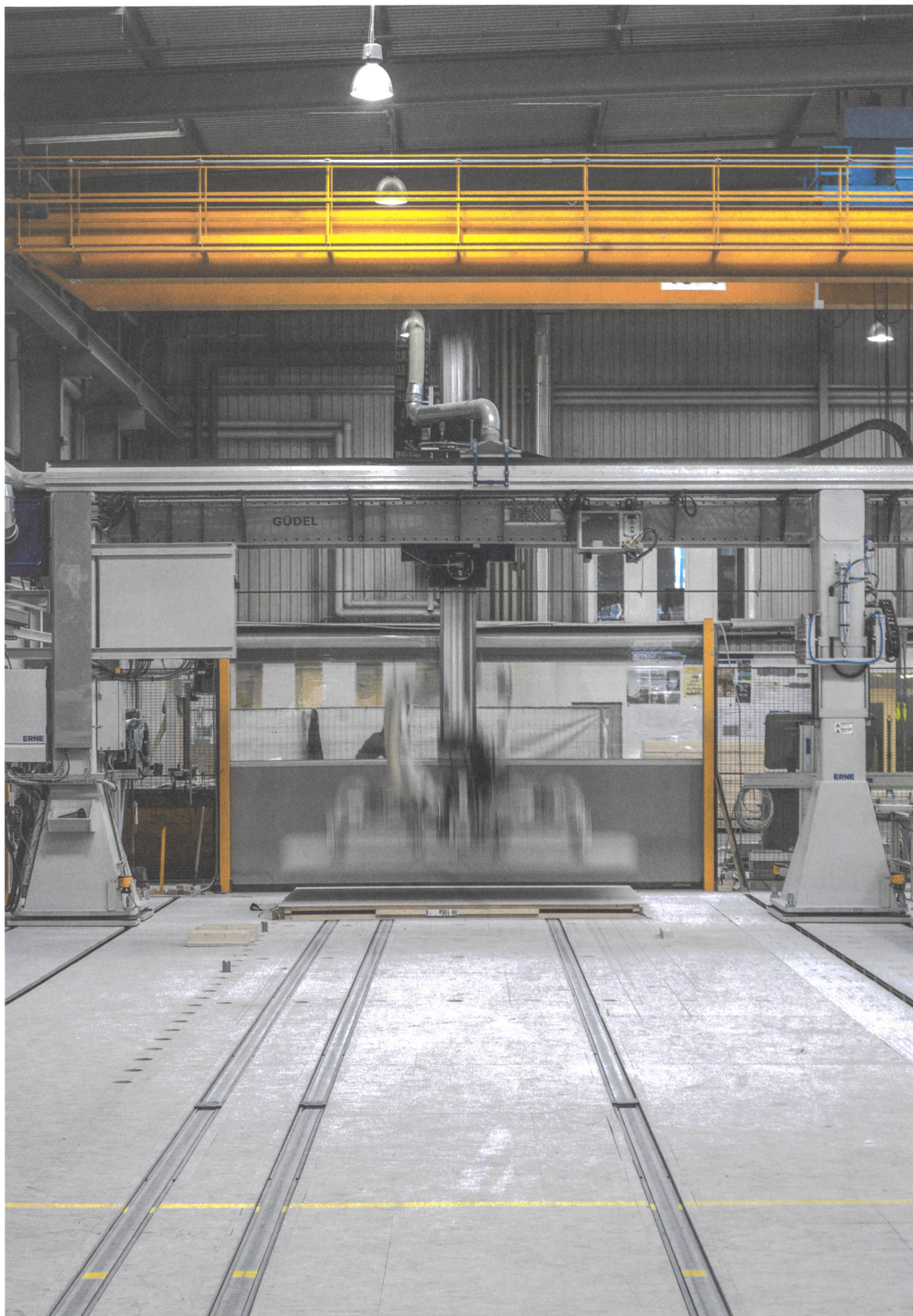
Multifunktionale Holzbearbeitung in der Werkhalle von Erne in Stein AG: Die «Woodflex 56» misst, sägt, bohrt, fräst und nagelt.
