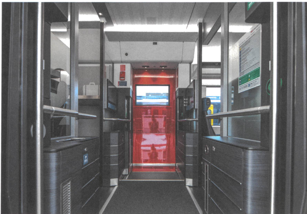
Beidseitig montierte Haltegriffe führen mobilitäts- und sehbehinderte Personen vom Einstieg bis zu ihrem Sitzplatz.
