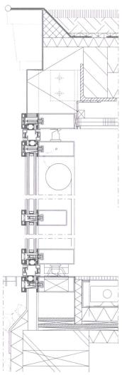
Detailschnitt Glasfassade: Die 1,8 Meter breite und 6,4 Meter hohe Wendetüre öffnet nach innen. Der Sonnenschutz ist in die Rahmentiefe eingelassen.
