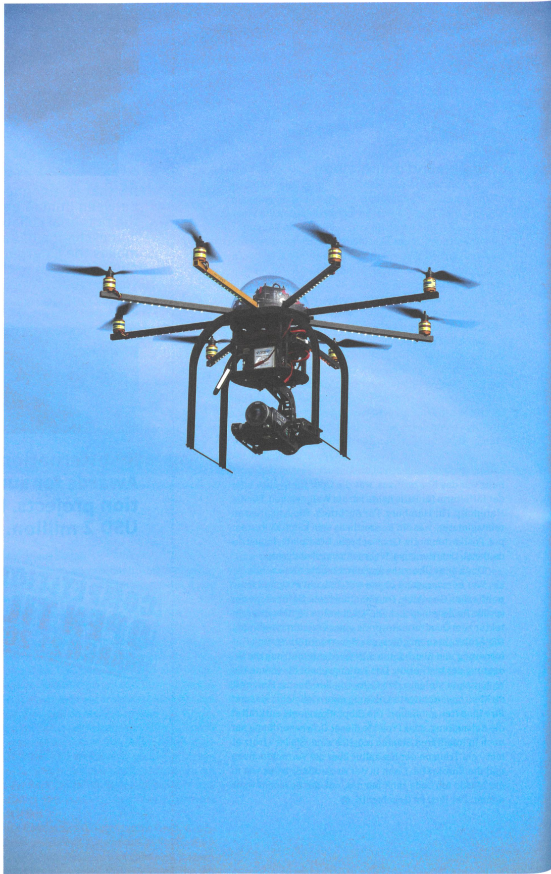
Drohne im Anflug: Dieser Oktokopter ist mit einer Videokamera ausgerüstet. Befestigt ist sie an einer Vorrichtung, die die Flugbewegungen dynamisch ausgleicht. Foto: Raini Sicher
