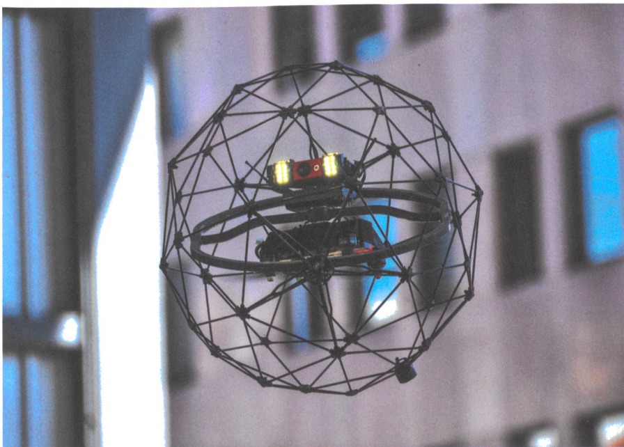
Bei der Drohne «Elios» stecken Motoren, Kamera und Elektronik in einem Schutzgitter. So kann sie Tunnels oder Industrieanlagen inspizieren.
