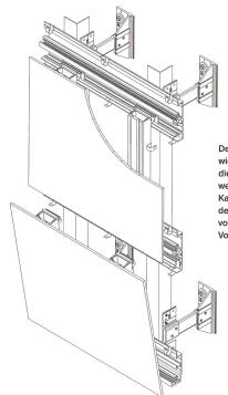
Der Systemschnitt zeigt, wie die Glasmodule dieser Fassade gehalten werden. Nur noch die Kabelführung unterscheidet die Konstruktion von einer herkömmlichen Vorhangfassade.
