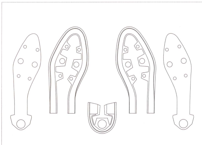
Schuhsohle durch fünf geteilt: So können die Designer Stefan Rechsteiner und Patrick Rüegg alle Schuhgrößen links und rechts herstellen.
