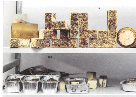
Dirk Hebels Bausteine bestehen nicht aus gebranntem Lehm. Sägemehl wird von einem Pilz zusammengehalten. Foto: Wojciech Zawarski
