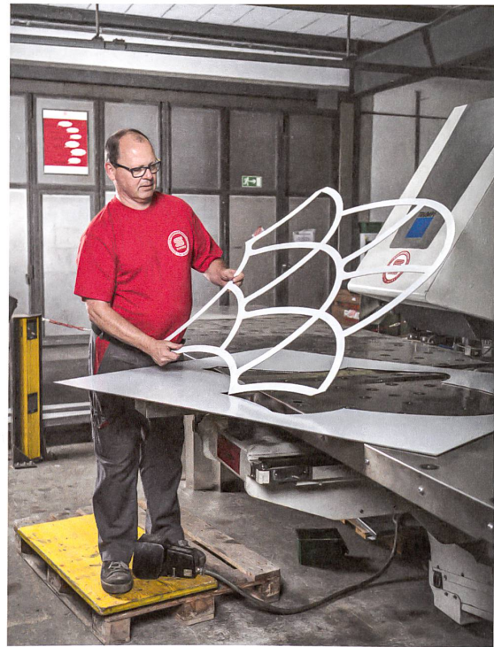
Der Spengler Rolf Märki prüft ein ausgestanztes Element des Gemeindehauses Unterengstringen, dahinter die «TruPunch 1000».
