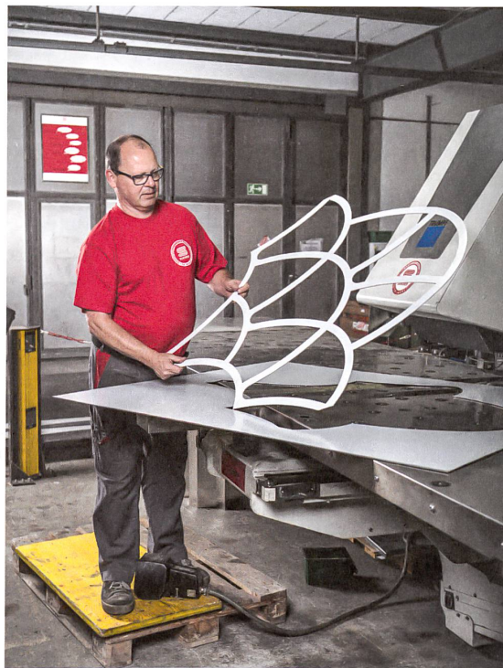
Der Spengler Rolf Märki prüft ein ausgestanztes Element des Gemeindehauses Unterengstringen, dahinter die «TruPunch 1000».
