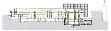
Längsschnitt durch das Brückengebäude über den Perrons des Bahnhofs.
