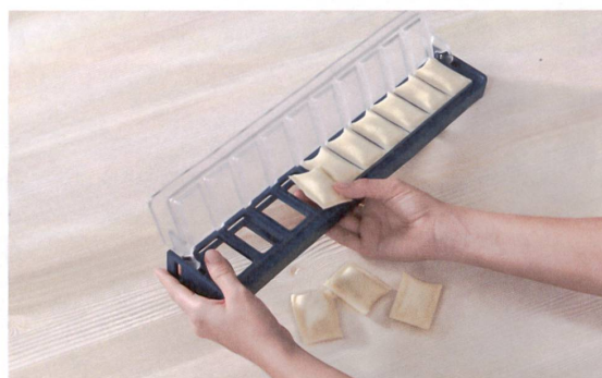
Der «Täschler MiniMaxi» vereinfacht die Produktion: Teig rein, Füllung verteilen, umklappen und zehn Taschen durchdrücken.
