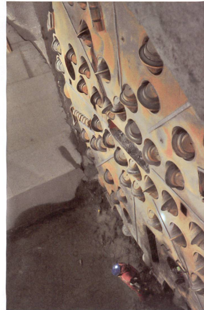
Tunnelbohrmaschine: 8 Meter Durchmesser, 160 Meter lang, 1500 Tonnen schwer.
