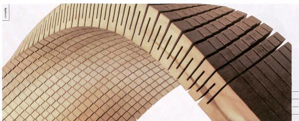
Höchstpräzis. Das Dukta-Schnittverfahren macht Holz flexibel und verleiht ihm nahezu textile Eigenschaften. In 5 Schnitten verfügbar für Sperrholz, MDF und Dreischicht-
