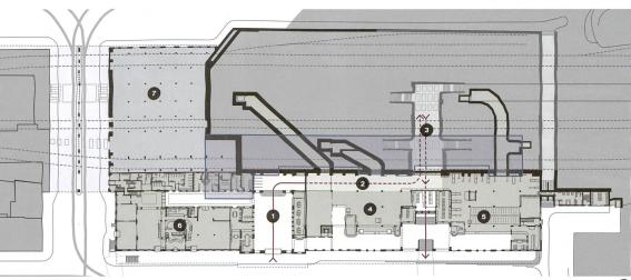
Erdgeschoss 1934: Ankommende und abreisende Passagiere sind getrennt, nur eine Unterführung erschliesst die Gleise.
