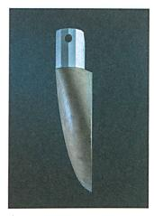
Die Leuchte entsteht auf der Baustelle: Die weisse Büchse für das Leuchtmittel ist über die Polyurethanform gestülpt, die nach dem Giessen entfernt wird.
