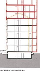
Querschnitt mit der Auszeichnung der abgebrochenen und neuen Teile.
