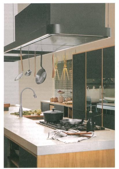
Atelier Oï hat die Küche ‹Aurélie Späti› entworfen: In die rund 500 Kilogramm schwere Abdeckung aus hellem Beton sind ein Gaskochherd und eine grosse Spüle mit aufliegendem Rüstbrett integriert.
