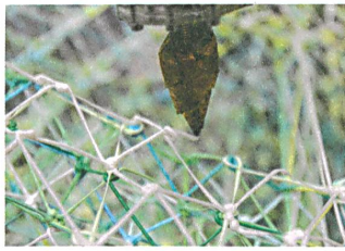
Vom Roboterarm geführt, zieht die Schmelzdüse das Kunststoff-Filament in den Raum.
