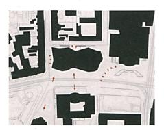
Im Schwarzplan stellen die Architekten die Einflüsse der Umgebung dar, die den Baukörper formten.
