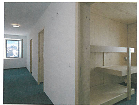
Der Gang: aus Brandschutzgründen nicht holzsichtig. | Le couloir est sans bois apparent pour des raisons de protection incendie.
