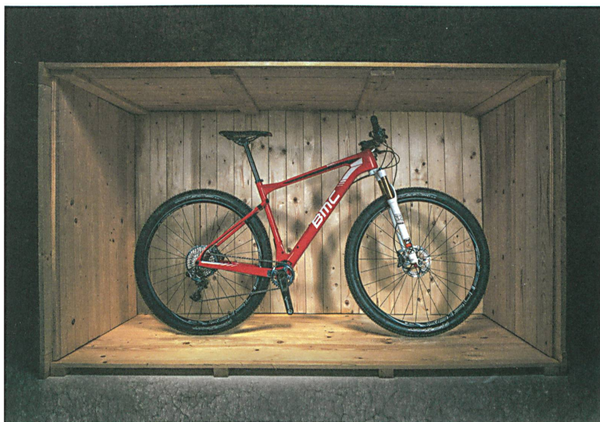
Das «Team Elite 01» ist ein Hardtail-Mountainbike mit einem nachgiebigen Hinterbau.
