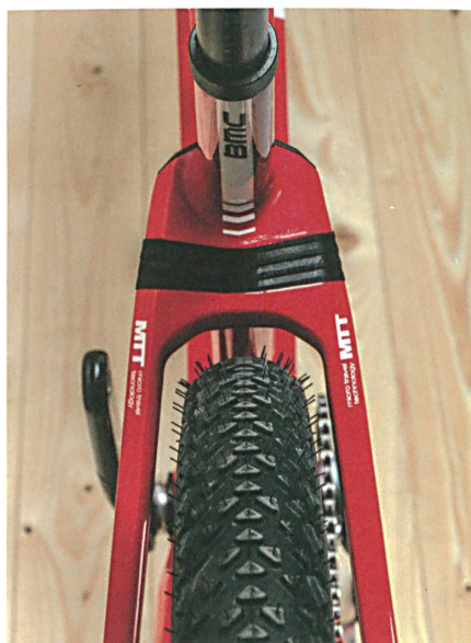
Die Strebe vom Sattelrohr zur hinteren Radnabe ist unterbrochen und mit schwarzem Polyurethan ausgeschäumt. Zwei unsichtbare Stifte sorgen für Verbindung und Stabilität.
