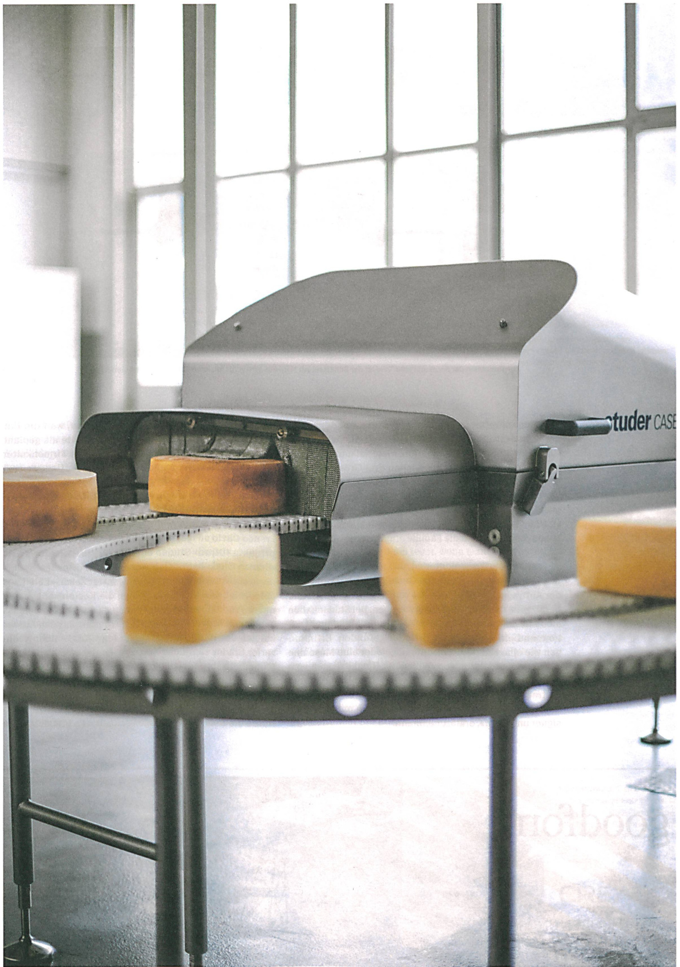
«Wo nichts ist, kann auch nichts verschmutzen», sagt der Designer Christian Lehmann. Die eigenwillig geformte Maschine mit präzise gesetzten Schrauben reinigt Käselaike.
