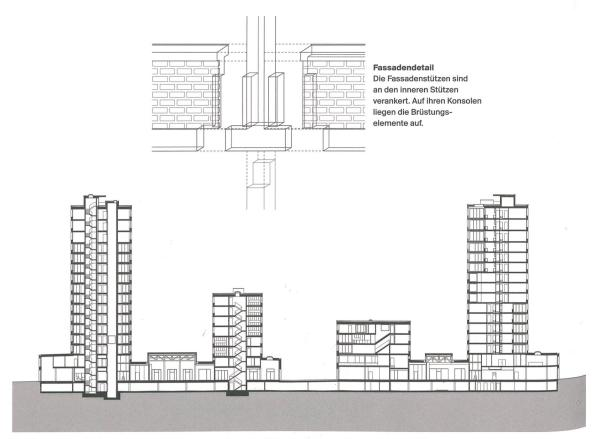
Der Längsschnitt zeigt das durchgehende Untergeschoss, den in der Mitte unterbrochenen Sockel mit den vier Häusern und den beiden Hallen.
