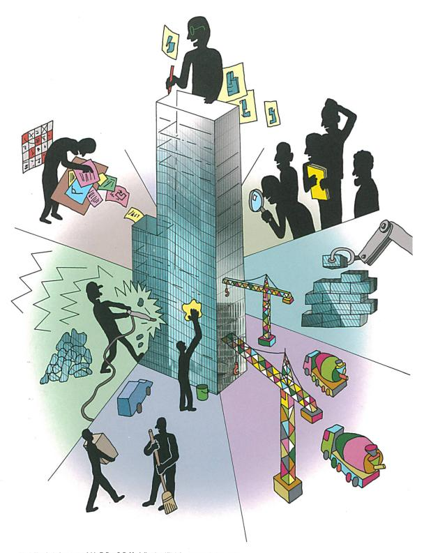
Modellbasiert planen von A bis Z: Das 3-D-Modell unterstützt den ganzen Lebenszyklus eines Bauwerks, im Uhrzeigersinn, vom Entwurf über die Ausführungsplanung zur Kontrolle. Auch die digitale Fertigung und die Baustellenorganisation profitieren vom Modell. Schliesslich liefert es Daten zum Unterhalt und Betrieb, zum Umbau oder gar zum Abbruch.
