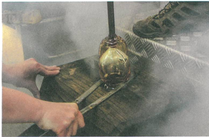
Beim Einblasen in die Form wird das Glas eingeschnürt.
