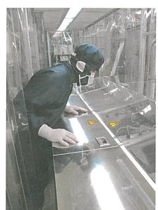
Ein Mitarbeiter im Reinraumanzug überwacht das Waschen der Substrate, auf denen die OLED entstehen.
