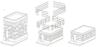
Die Explosionsaxonometrien illustrieren den konstruktiven Aufbau der (Bunateka).
