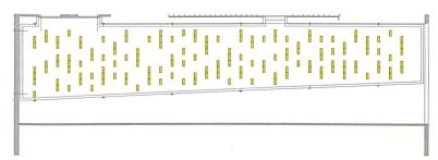
Die 150 an die Decke montierten OLED-Leuchten fügen sich in einem unregelmässigen Raster zu 31 Reihen.
