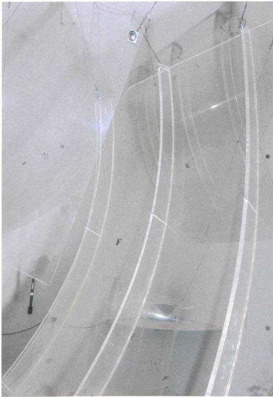
Im Hallraum sind Reflektoren aus Plexiglas notwendig, um ein für die Messungen ideales, diffuses Schallfeld zu bilden.
