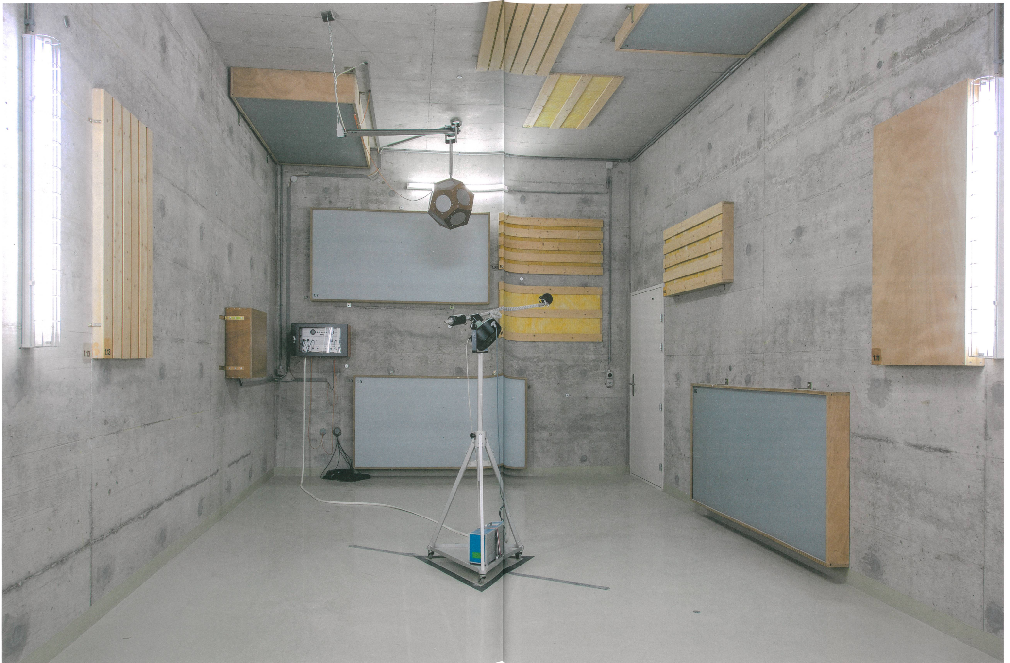
Die Empa in Dübendorf misst die Luftschalldämmung von Holz-, Ziegelstein- und Gipsständerwänden. Hier wird Schall gesendet, im Raum nebenan empfangen.
