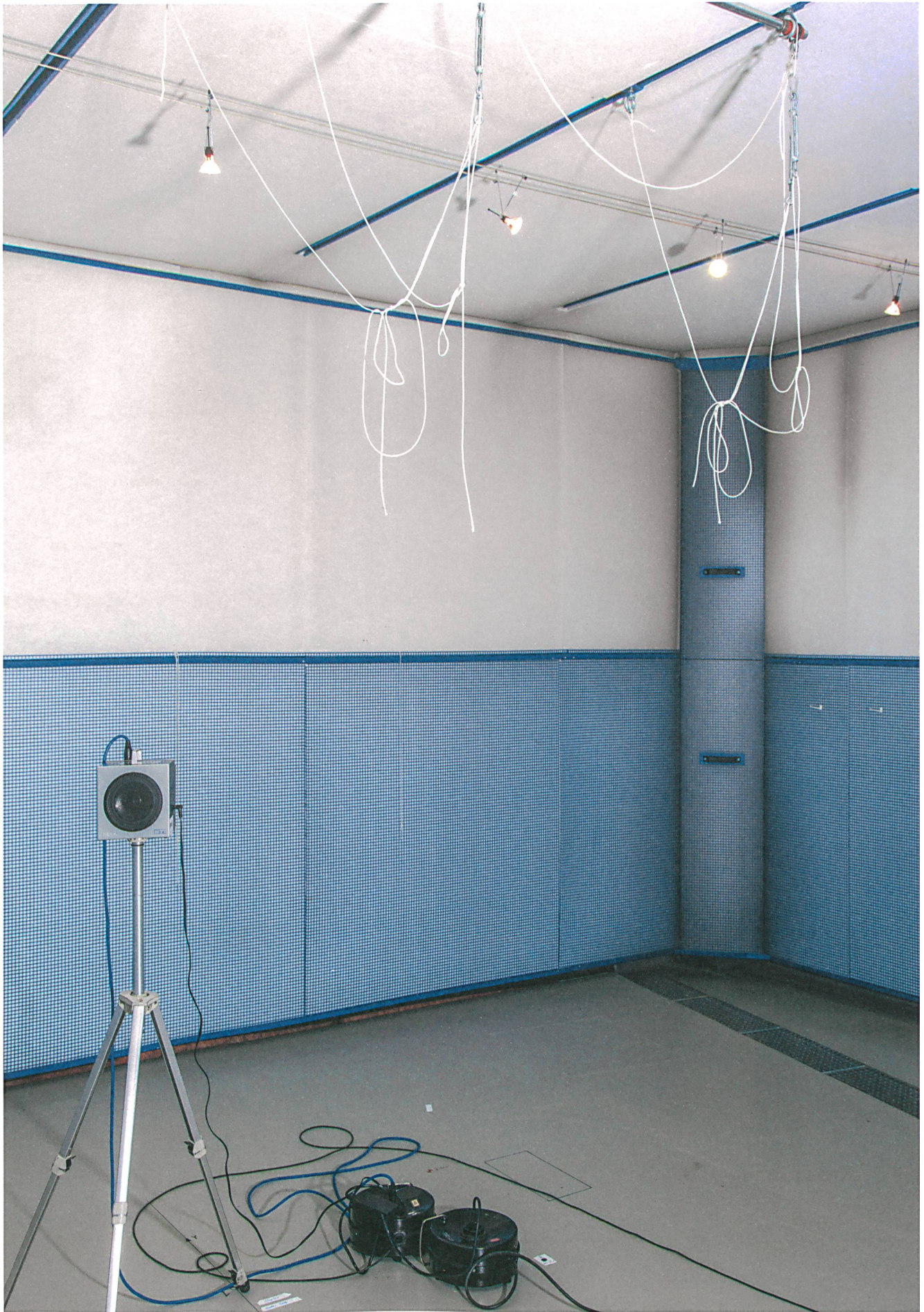
Experimentieren im Schallhaus der Empa in Dübendorf: Der halb reflexionsfreie Raum klingt, als hätte er weder Decke noch Wände. Sie sind vollständig schallabsorbierend.
