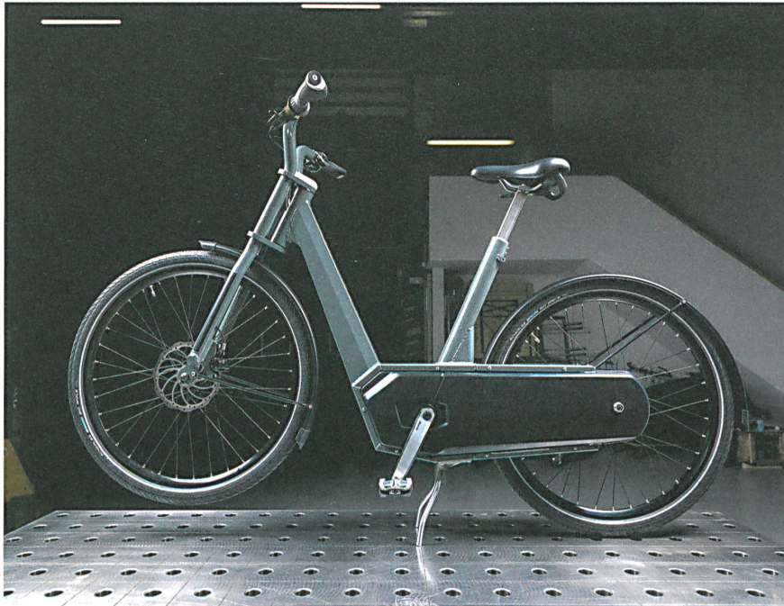
Designwerk entwickelt ein Velo für den Verleih: In der Ridebox sind alle empfindlichen Teile sicher versorgt.
