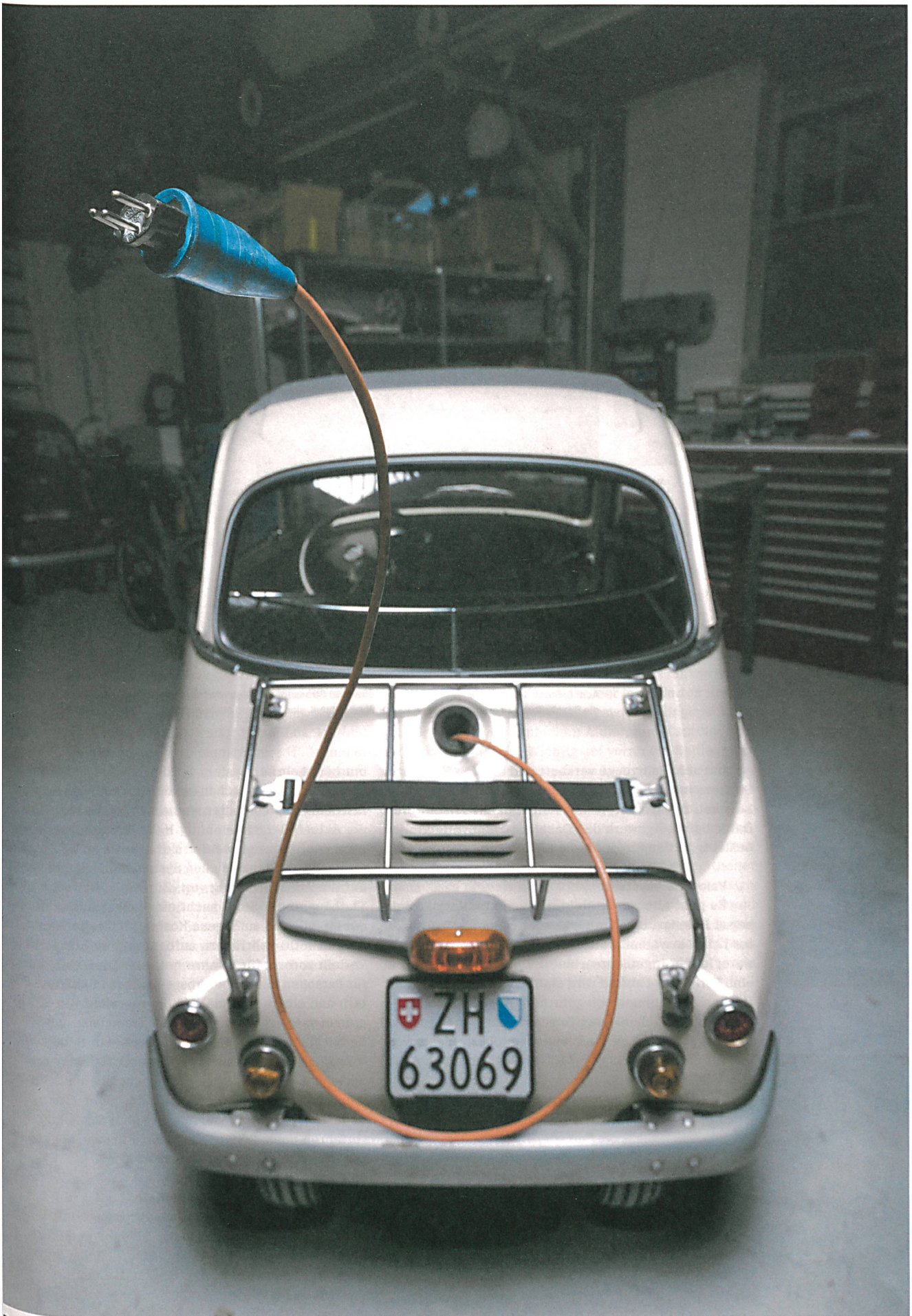
Die Ingenieure in Fehraltorf haben eine BMW iSetta aus den Fünfzigerjahren zum Prototypen für ein leichtes Elektromobil umgebaut.
