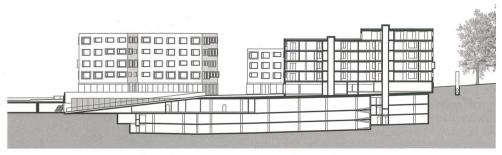
Längsschnitt: Von der umgestalteten Bahnhofsunterführung führt eine Rampe direkt auf den Bleicheplatz.
