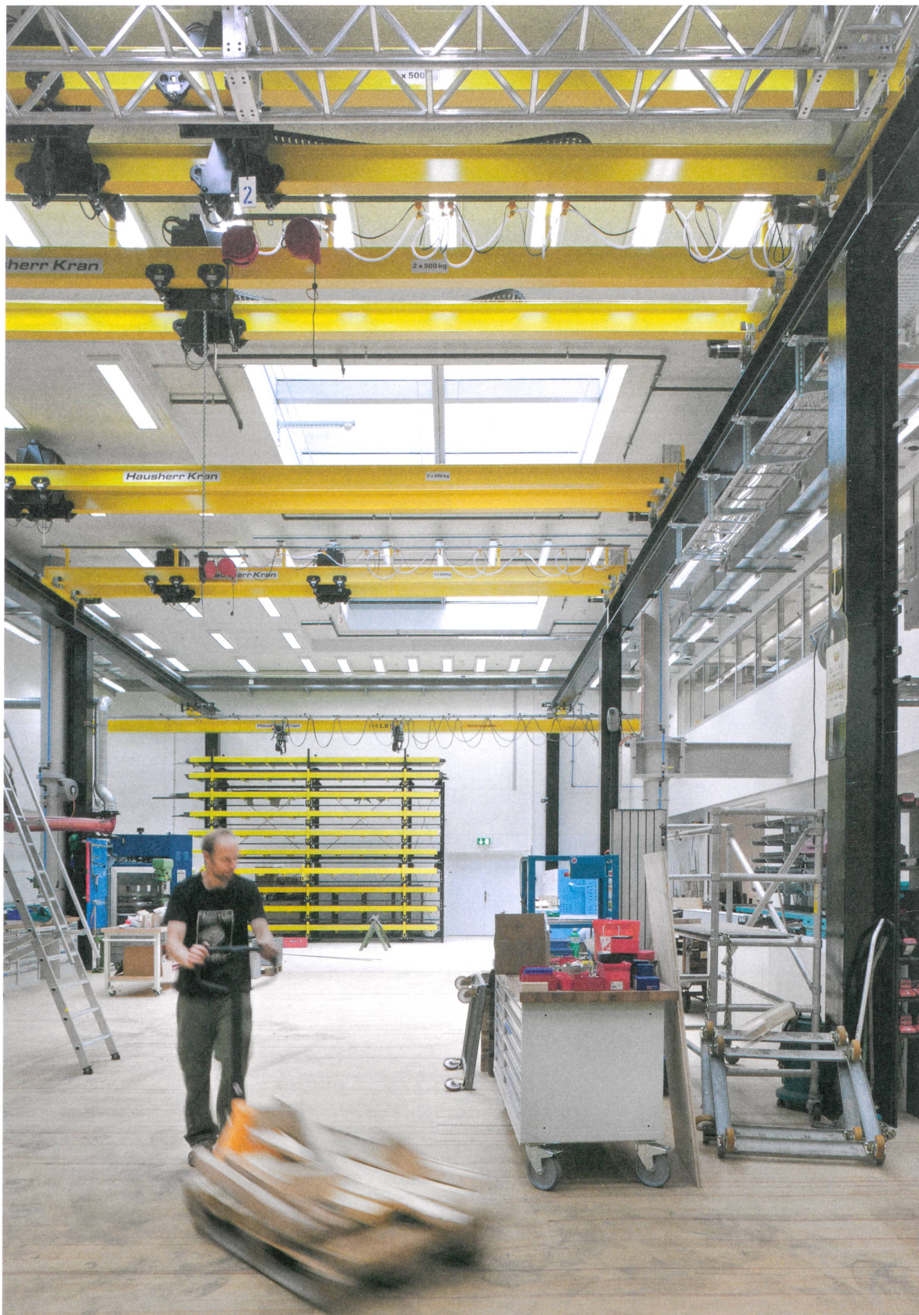
Licht bis in die Tiefe: Die Werkstätten sind im Bauch des Gebäudes versorgt, aber dank Oberlichtern im Boden der Lichthöfe trotzdem hell.
