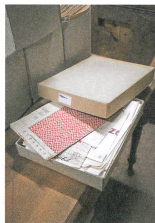
Die Jacquardpatronen steuerten die Kettfäden der Webmaschine.
