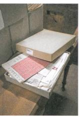
Die Jacquardpatronen steuerten die Kettfäden der Webmaschine.
