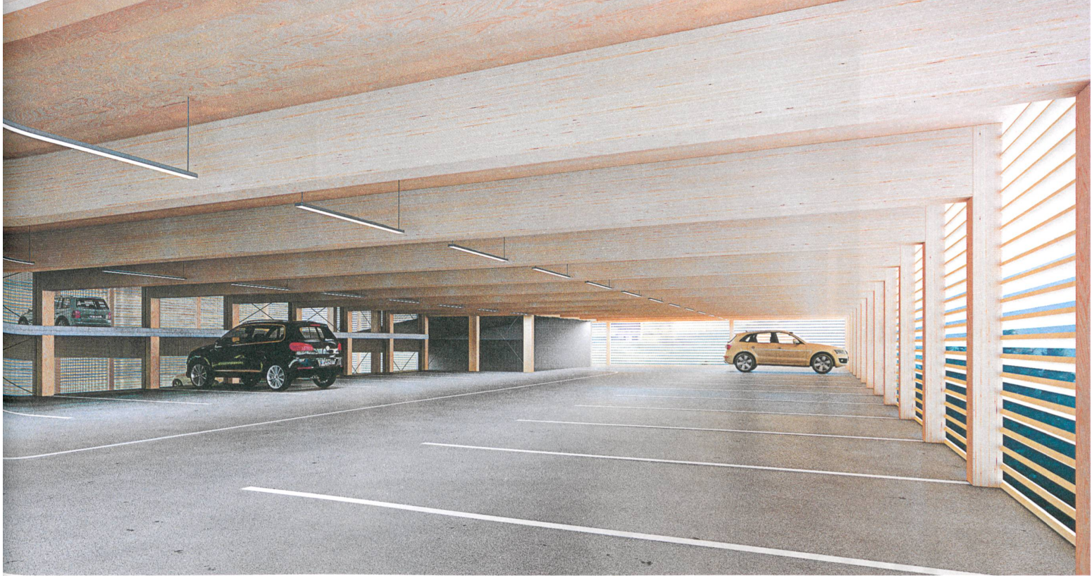
Parkhaus als konstruktiver Holzbau mit BauBuche, Unterzüge und Stützen aus BauBuche GL70, Deckenuntersicht aus BauBuche Platten. Forschungsprojekt der TUM.Wood unter Beteiligung der Professoren Hermann Kaufmann, Florian Nagler, Stefan Winter, Klaus Richter, Jan-Willem van de Kuilen.
