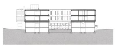
Querschnitt: Stahlträger im Hof steifen die Aufstockung aus.
