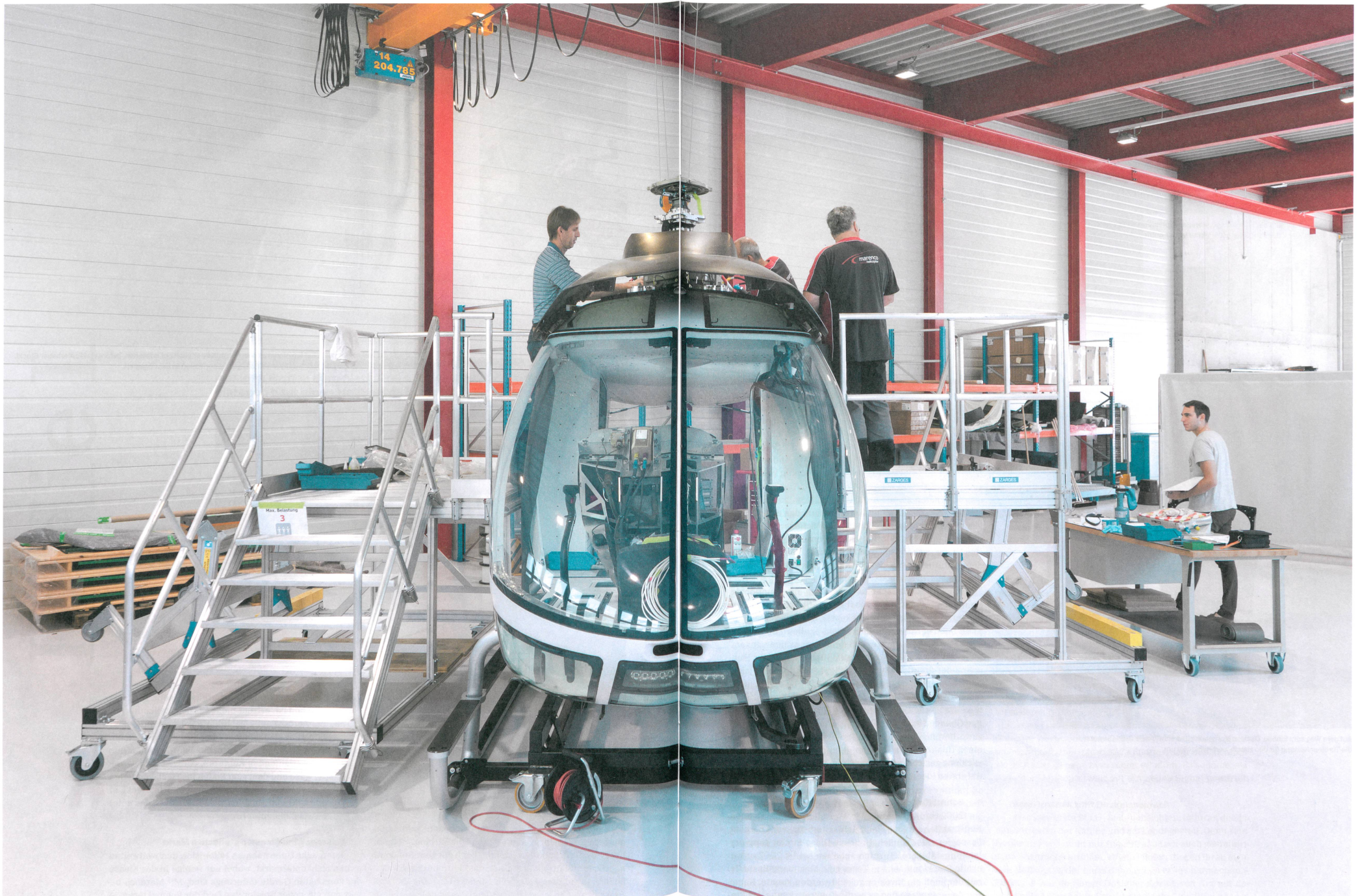
Das fast völlig gläserne Cockpit bietet dem Piloten gute Sicht auch nach unten. Ein markantes Plus, vor allem beim Transport von Aussenlasten.
