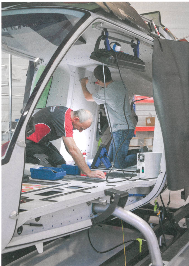
Die Türen an den Seiten und am Heck bieten optimale Zugänge. Avionik und Tank befinden sich in den vertikalen Boxen im Heckbereich.
