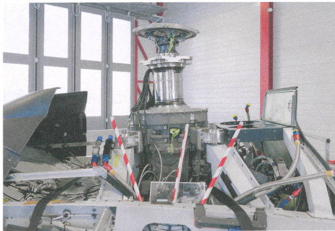
Hier wird der fünfblättrige, vibrationsoptimierte und gelenklose Rotor installiert. Dank der Verkleidungselemente ist der Antrieb einfach zugänglich.
