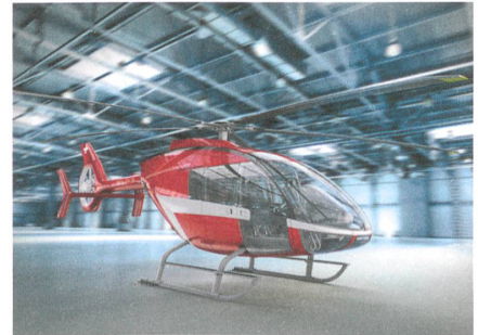
So wird er aussehen: Der «Skye SH09» soll 1,5 Tonnen zuladen oder bis zu 7 Passagiere mit Tempo 260 durch die Luft bewegen können. Visualisierung: Marengo
