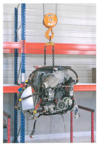
Auf dem Weg zum Einbau: Das von Marenco selbst entwickelte Getriebe setzt die Turbinenleistung für den Haupt- und Heckrotor um.
