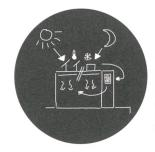
Temperaturhaushalt: Strom und Wärme vom Dach oder die nächtliche Kaltluft kühlen oder wärmen jeden Raum. | Temperature control: power and heat from the roof and the cool night-time air are used for heating or cooling each room.
