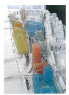
Die «envelopes», die das erlaubte Volumen zeigen, und die «infills» vom Büro KCAP im Modell zur Testplanung. I De «envelopes» die het toegestane volume laten zien en de «infills» van het bureau KCAP in het model voor de testplanning.
