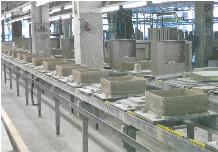
Dank höherer Festigkeit der Saphir-Keramik sind schärfere Kanten möglich: vorne Rohlinge der Serie «Living Square».
