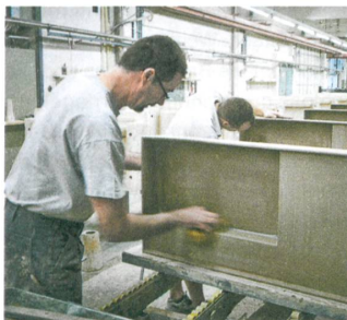
Die Produktion: garnieren, entgraten, putzen, schwämmen und inspizieren.
